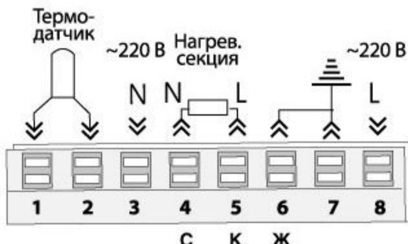
**С** – синий провод нагревательной секции SPYHEAT
