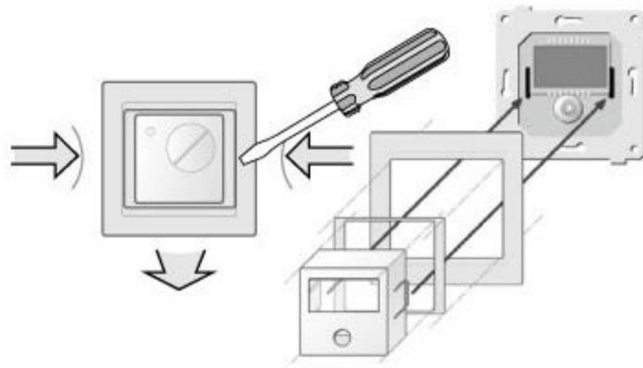
6.2 Установить корпус термостата. Подключить провода питания, нагревательную секцию или нагревательный прибор (нагрузку) и выносной датчик температуры. Присоединяемые провода должны иметь сечение 0.75-2.5 мм<sup>2</sup> в зависимости от мощности нагревательных приборов. **Нагрузка мощностью более 3500 Вт подключается через магнитный пускатель.**
